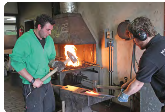
Herstellung eines geschmiedeten Geländers (Metallgestalter)
